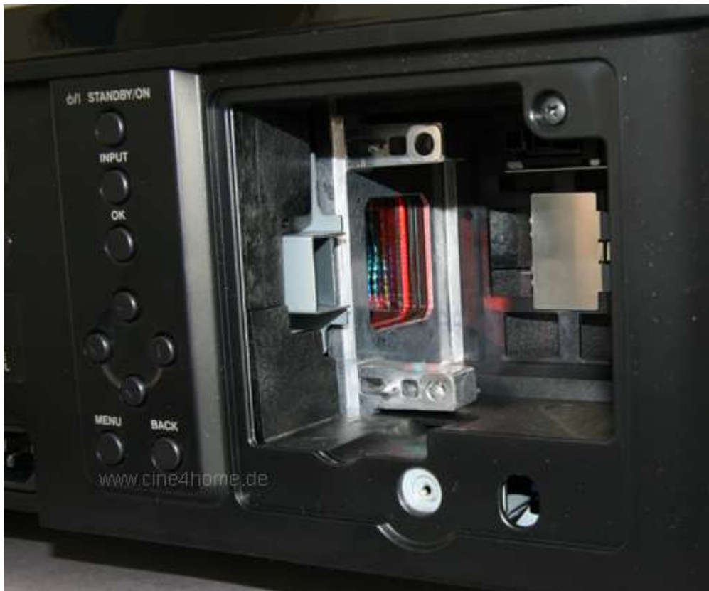
Lampenschacht und Beginn des Lichtweges
